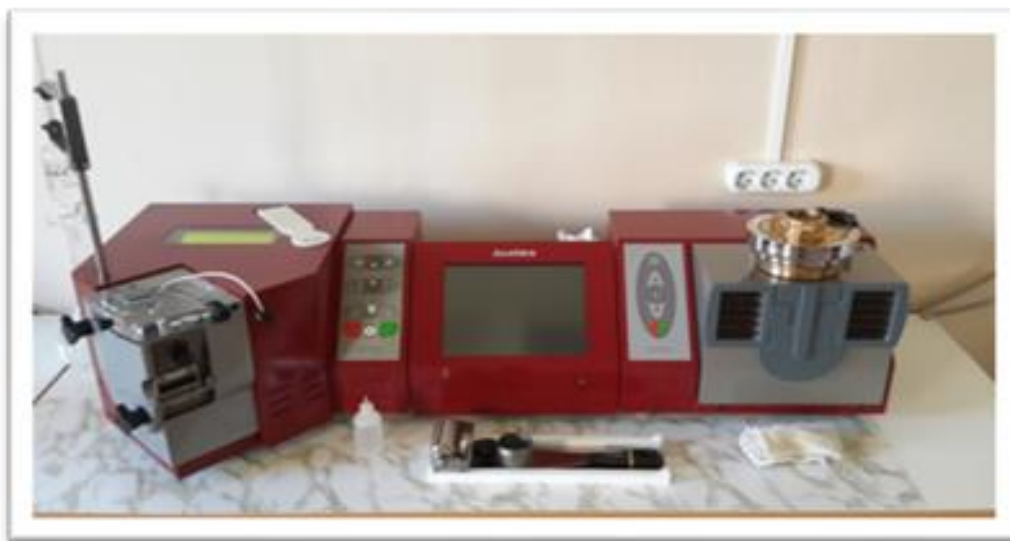
Сурет 1 - Альвеограф (қамырдың серпімділігімен созылғыштығын анықтайды)
